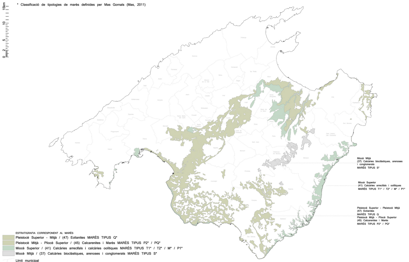
Fig. 8: Estratigrafia geològica dels diferents tipus de marès. (Elaboració pròpia, 2012).
